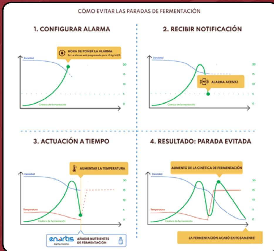
La monitorización continua de diferentes parámetros de la fermentación a través de los sensores WINEGRID, combinada con un conocimiento exhaustivo de las necesidades nutricionales de la levadura en cada fase de la fermentación alcohólica y con el aporte de una nutrición equilibrada, da como resultado fermentaciones exitosas y que permitirán producir un vino de alta calidad.
